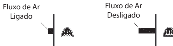
Figura 4–2 Posições Ativada/Desativada do Botão de Pressão
